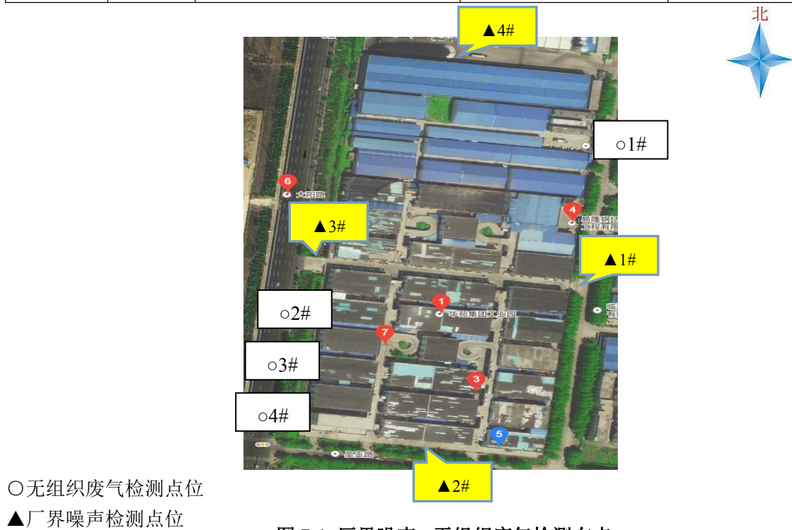
图 7-1 厂界噪声、无组织废气检测布点
