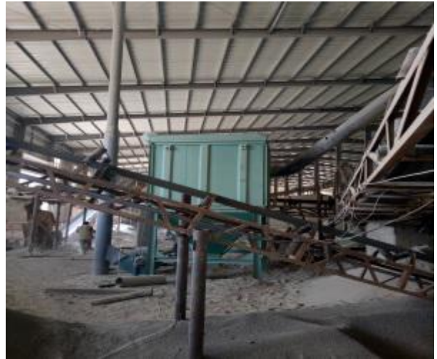
图 3-7 1#筛分机脉冲布袋除尘器
