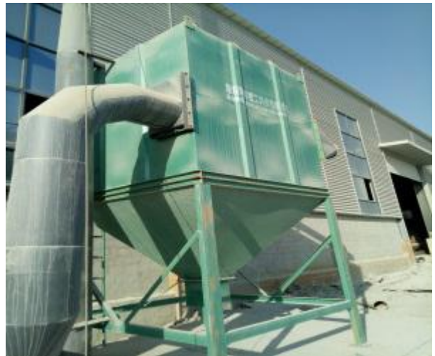
图 3-9 2#筛分机脉冲布袋除尘器
