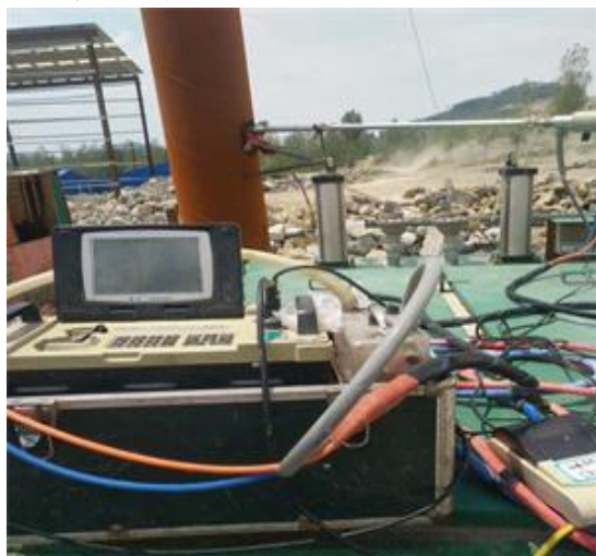
图 7-1 破碎工序废气采样平台
