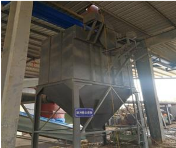
图 4-2 脉冲布袋除尘器
