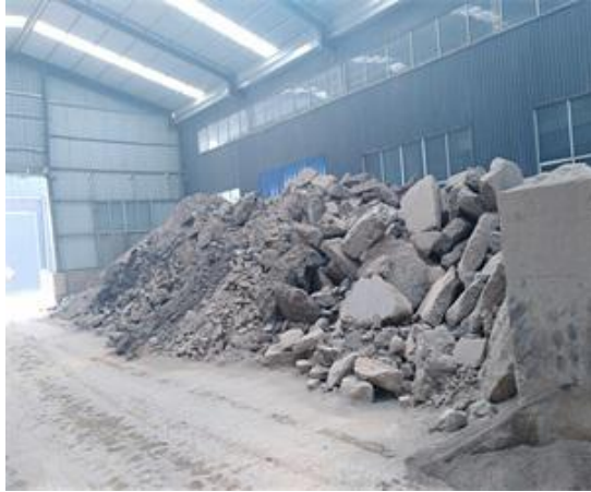
图 3-5 建筑垃圾原料
