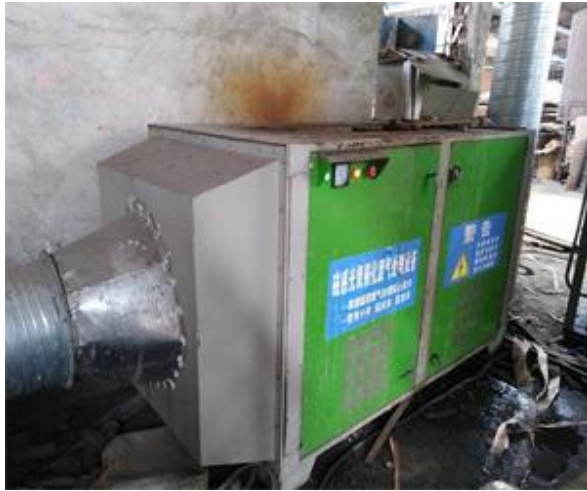
图 4-1 热压机用光氧催化装置
