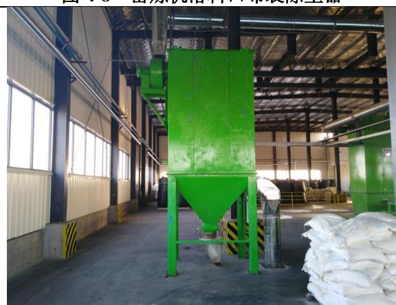
图 4-10 密炼机布袋除尘器
