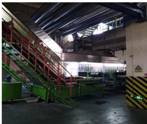
图 3-4 密炼中心胶片冷却线
