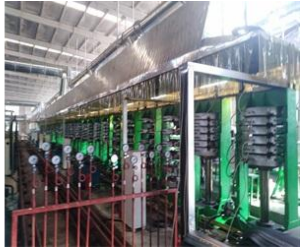
图 3-12 硫化机（成型硫化车间）
