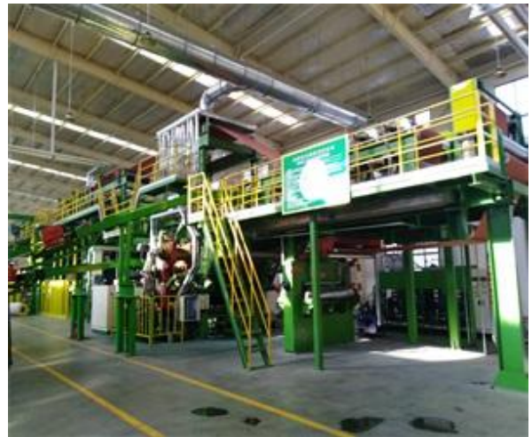
图 3-8 钢丝连线压延机（压延压出车间）
