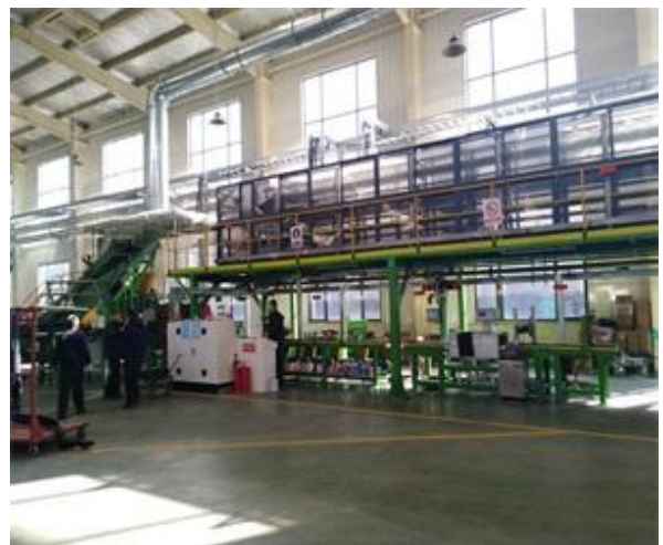
图 3-10 双复合冷喂料挤出机（压延压出车间）
