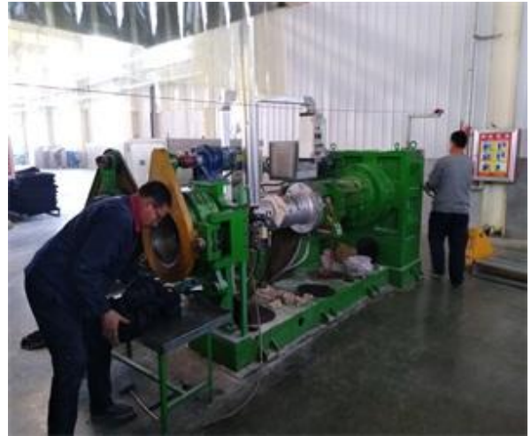
图 3-6 冷喂料滤胶机（内胎车间）
