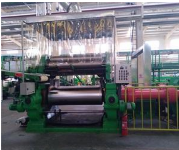
图 3-9 开炼机（压延压出车间）
