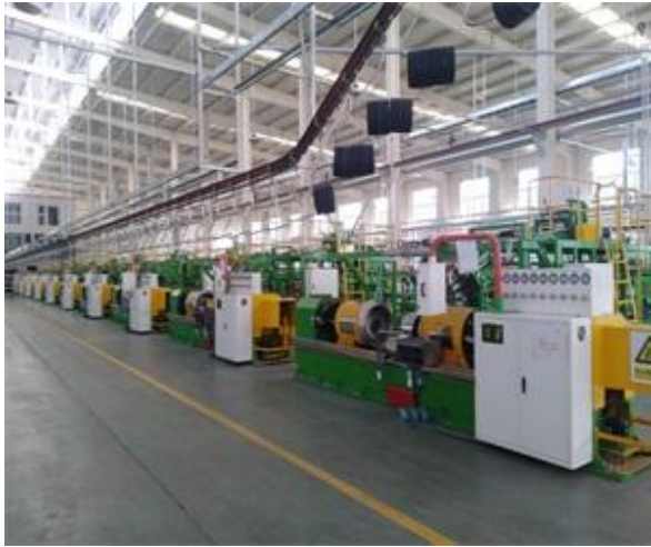
图 3-11 成型机（成型硫化车间）
