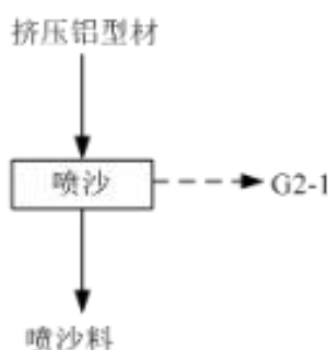
图 4-6 喷砂料生产工艺流程及产污环节图
