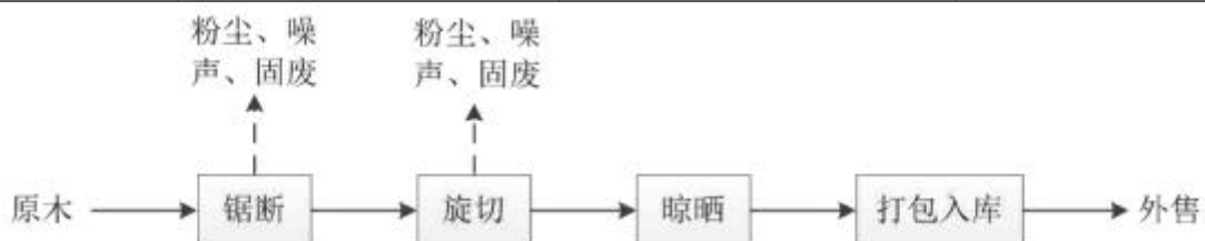
图 4-12 旋皮生产工艺流程及产污环节图
