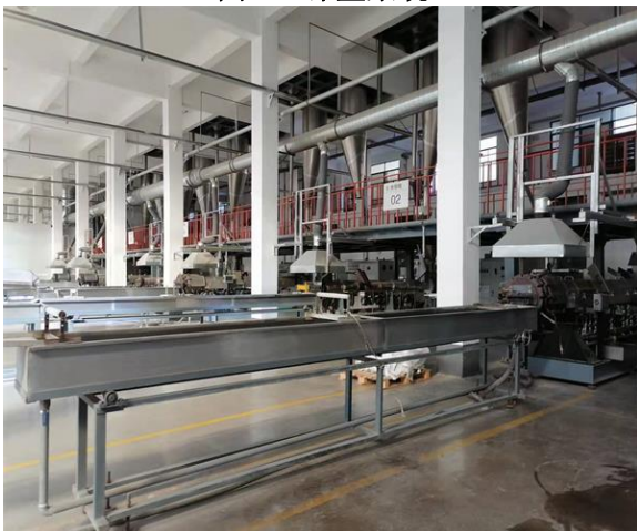
图 3-7 挤出机+冷却水槽
