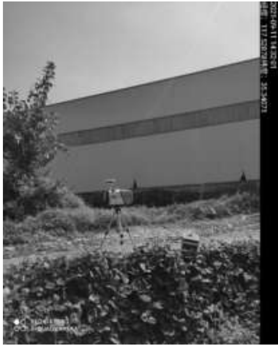
图 7-3 厂界无组织废气采样 (3#)
