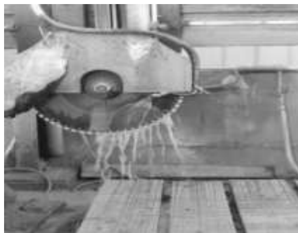
图 4-2 红外线切割喷淋系统
