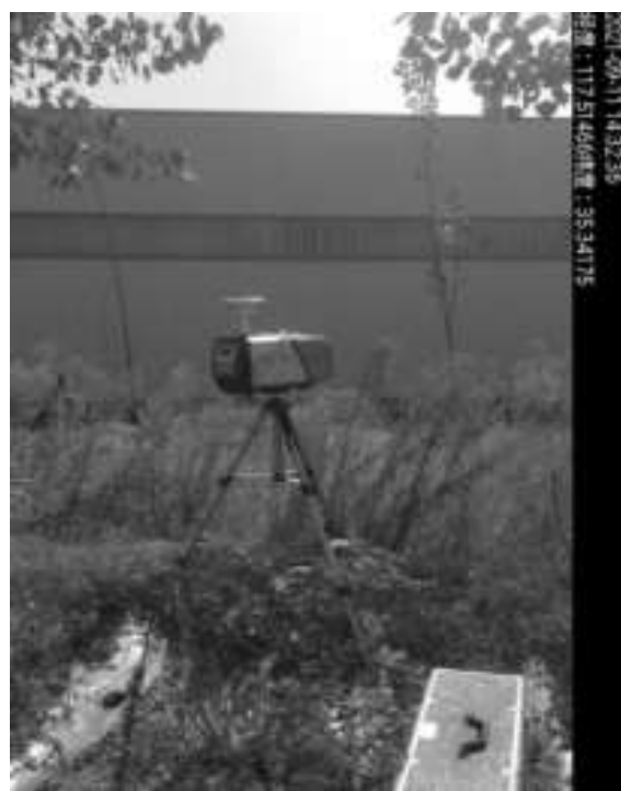
图 7-2 厂界无组织废气采样 (2#)
