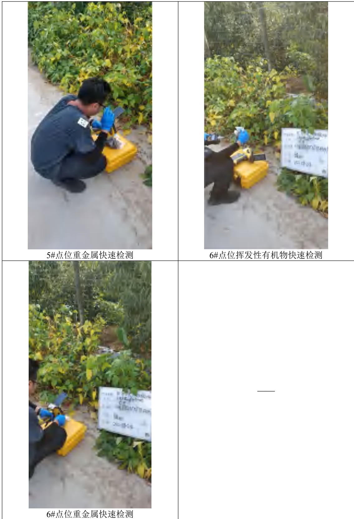
图 6-2 现场快速检测
