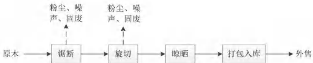
图 4-3 旋皮厂生产工艺流程及产污环节图
