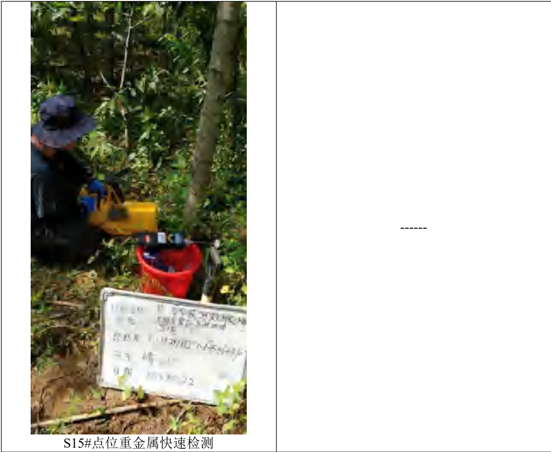
图 6-2 现场快速检测
