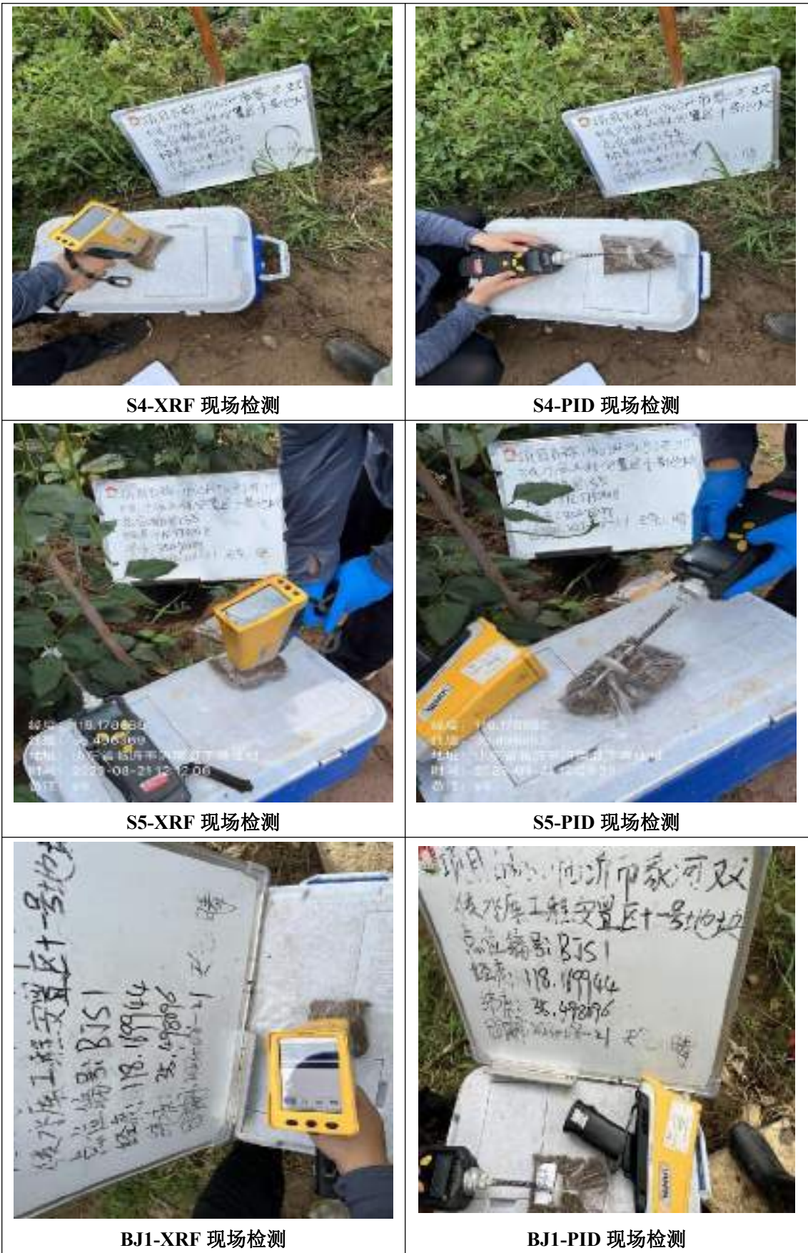
图 5-4 现场快速检测
