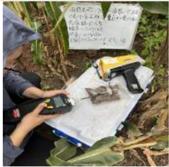
S5-PID 现场检测
