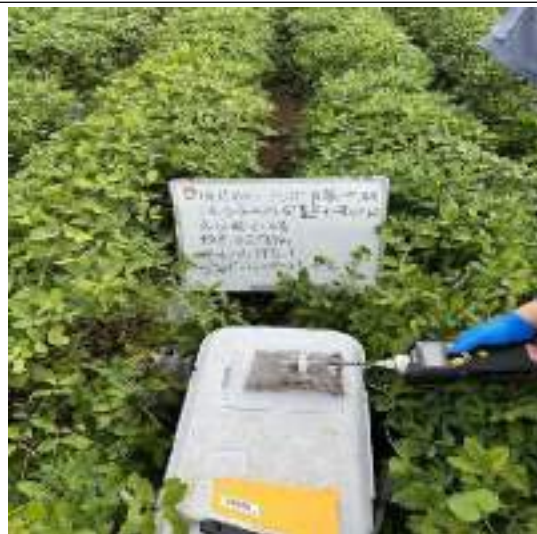
S3-PID 现场检测
