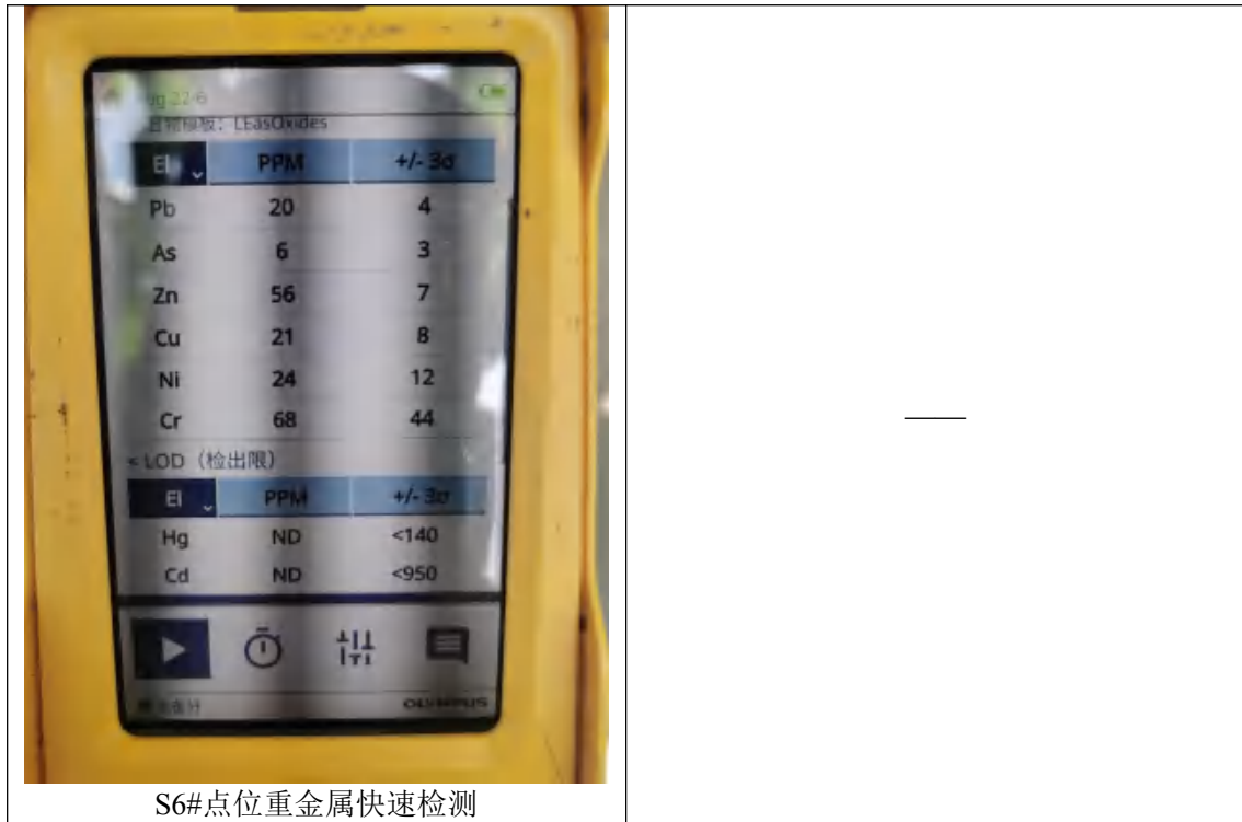
图 6-2 现场快速检测
