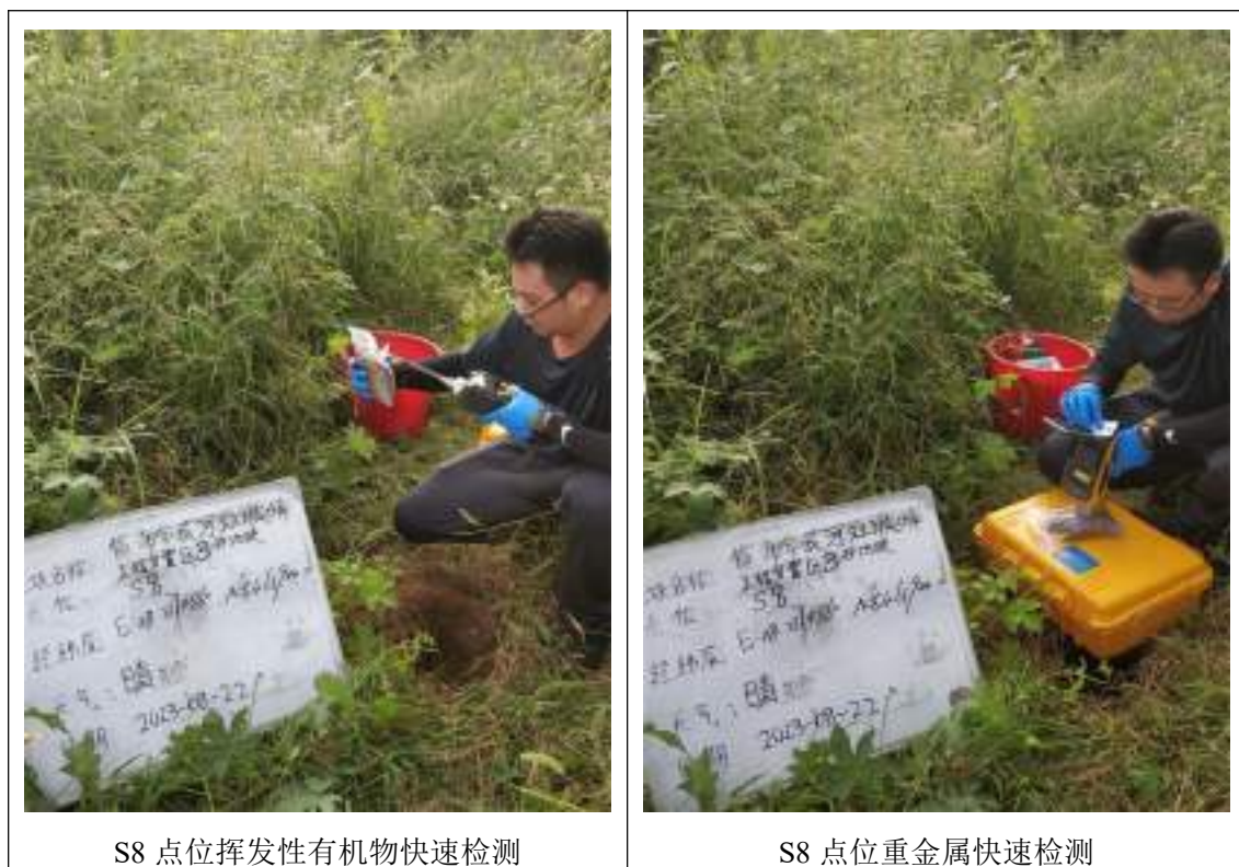
图 6-2 现场快速检测
