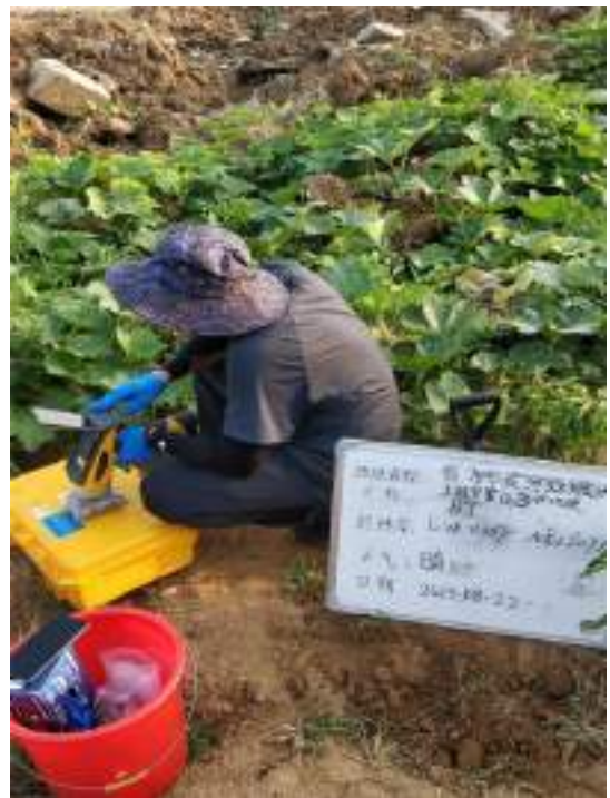
对照点重金属快速检测
