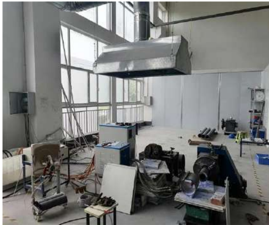
图 3-9 管道烧结（中频机）
