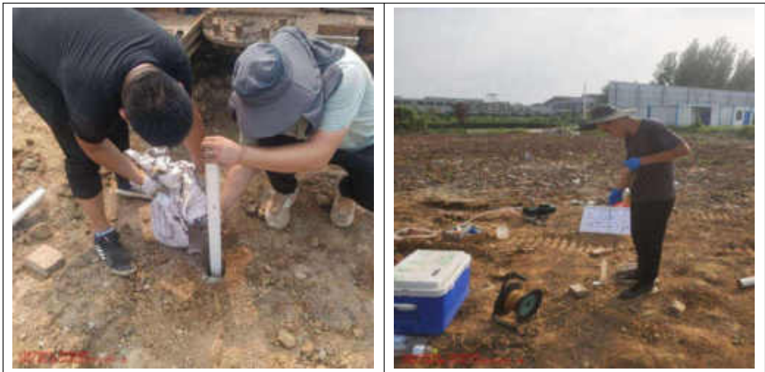
图 6-4 地下水建井、洗井过程
