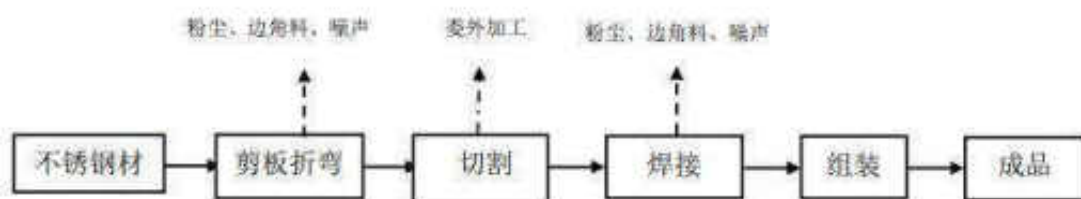
图 4-22 不锈钢标识广告牌生产工艺流程及产污环节图
