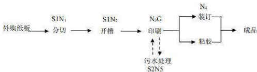
图 4-21 纸箱生产工艺流程及产污环节图
