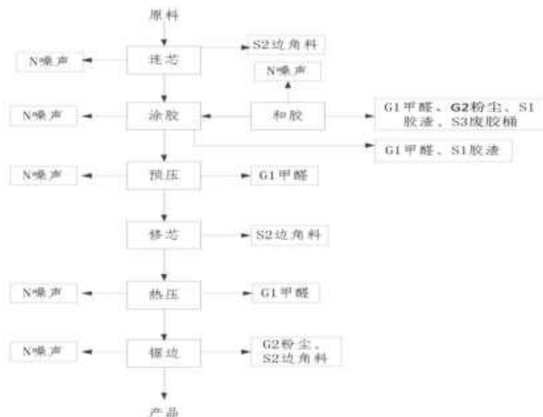
图 4-3 多层板生产工艺流程及产排污环节示意图
