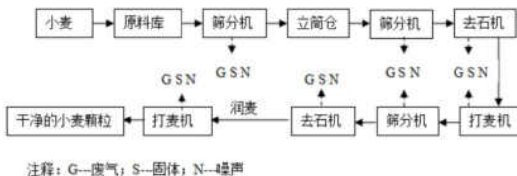
图 4-7 小麦颗粒的干式处理工艺流程图
