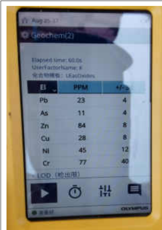
S5 XRF 重金属数据照片
