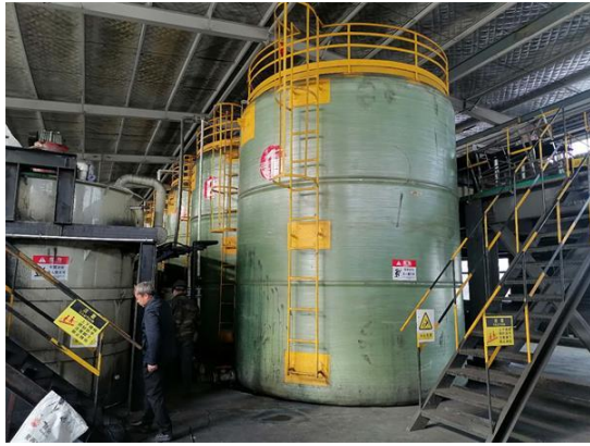
图 3-14 浸出液暂存罐及浸出反应釜
